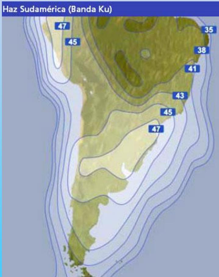
Se denomina zona de cobertura del satélite o “pisada” la superficie de la tierra delimitada por un contorno de densidad de flujo de potencia constante como se muestra en la figura.
