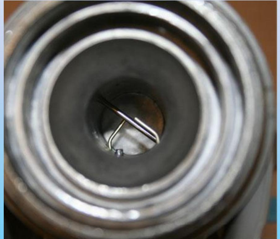
Vista del acceso (feeder) del LNB donde se distinguen los monopolos perpendiculares que permiten disponer de polarización horizontal o vertical seleccionable desde el decodificador mediante ajuste eléctrico.
